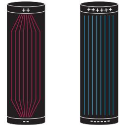
L'accu BL4040F présente une résistance interne particulièrement faible grâce à l'utilisation de cellules Li-ion à la composition chimique unique et un design "tab-less".
