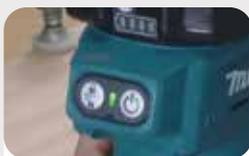
Interrupteur marche/arrêt et bouton de verrouillage distincts
